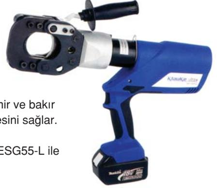
Klauke, Zırlı kablolar ve Çelik Özlü alüminyum iletkenlerin kesilmesi amacı ile ürettiği Kesme Makaslarına Mini Seride Ø25 mm çap'a kadar kabloları kesebilmek için ESG25-L yi geliştirdi. 18 V, 1,5 Ah batarya ile çalışan ESG25-L çelik özlü alüminyum iletkenler, dolu demir ve bakır malzemeler, alüminyum ve çelik gibi malzemelerin bir tetik hareketi ile 4 - 5 sn içinde kesilmesini sağlar.
